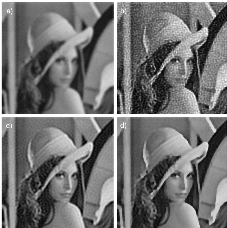
Obrázek 2.3: Srovnání dekonvoluce Richardson-Lucyho algoritmem při rozmazání Gaussovskou PSF s aditivním šumem (a) dekonvoluce bez regularizace (b), s TM regularizací (c) a s TV regularizací (d)
